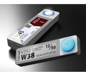
LEDピッキング電子ラベルは、LED付押しボタンと電子ペーパーによりリアルタイムに出荷指示ができるピッキング用電子表示器です。表示部には視認性の高い4.3インチ電子ペーパーを採用、品名、数量、バーコードなどを表示できます。確認用の押ボタンは、操作し易いように大きくデザインされ、しかも7色のマルチカラー LEDです。
